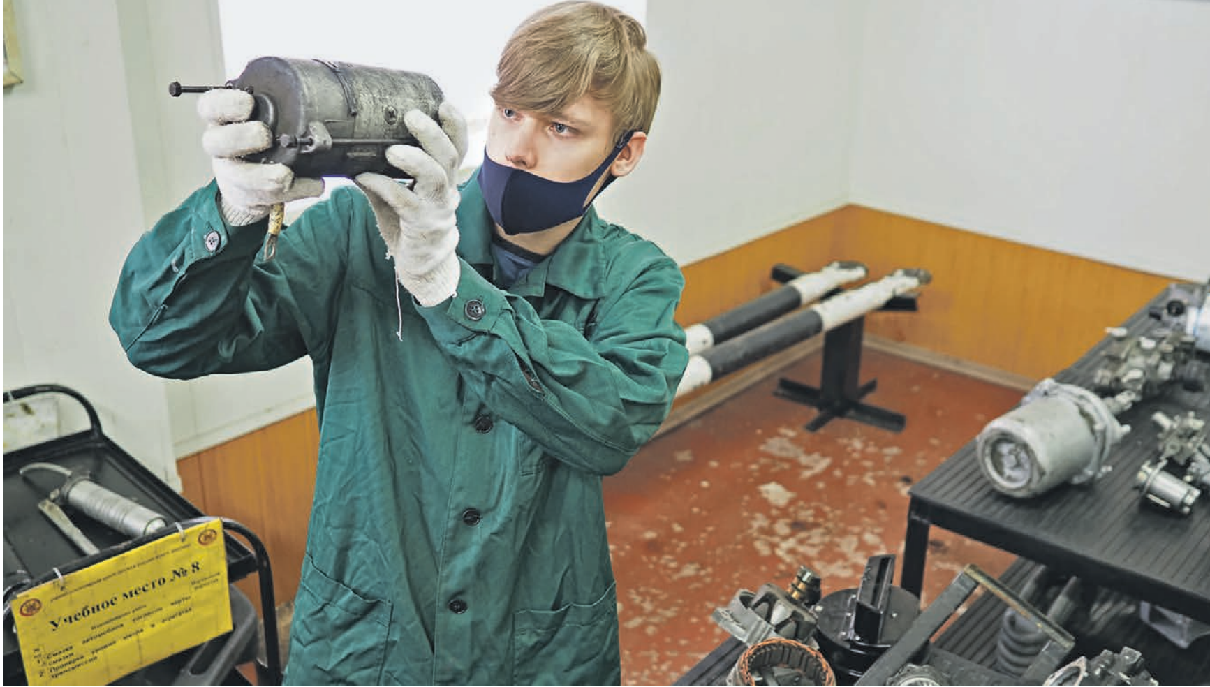
Вчера 13:26 Курсант учебного центра ДОСААФ по Южному административному округу Глеб Левин проверяет обмотку крышки стартера на практическом занятии. Юноша готовится к сдаче экзамена на водительские права в Государственной инспекции безопасности дорожного движения
