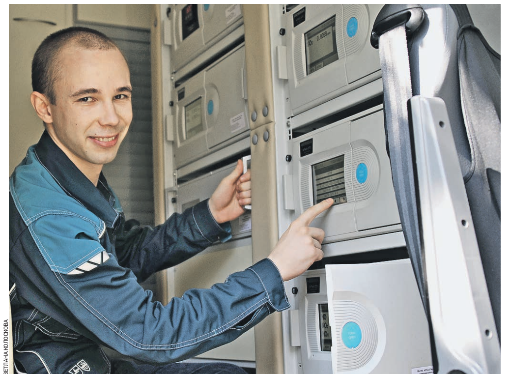
14 июня 2020 года. Инженер сектора оперативного контроля Мосэкомониторинга Георгий Покрытан проверяет показания автоматических экспресс-газоанализаторов
