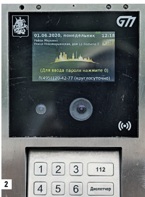
Диспетчер Тереза Мищенко может следить за состоянием коммуникаций дистанционно (1) Этим домофоном можно управлять онлайн с помощью приложения. С его помощью жители дома могут видеть изображение с камеры или открывать двери (2)
