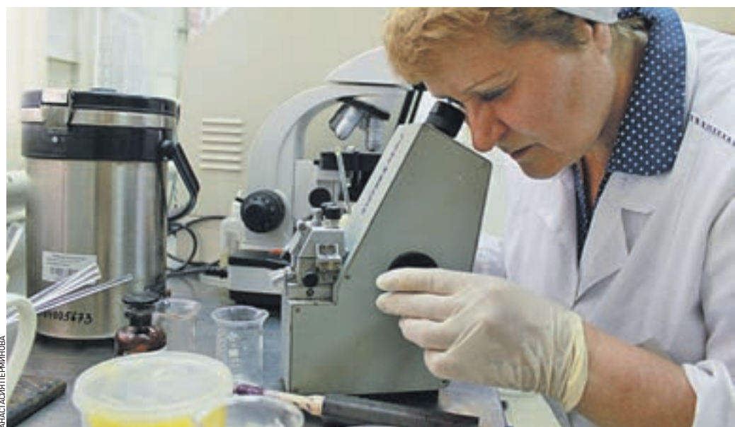
5 августа 2015 года 13:15 Ветврач Ольга Комарова определяет влажность меда с помощью рефрактометра. Если этот показатель превышает норму, мед начнет бродить
