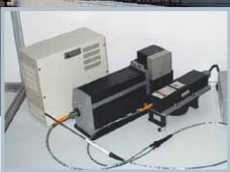
Акустооптический рамановский спектрометр для определения качества алмазов (разработка НТЦ УП РАН и ВНИИФТРИ).
